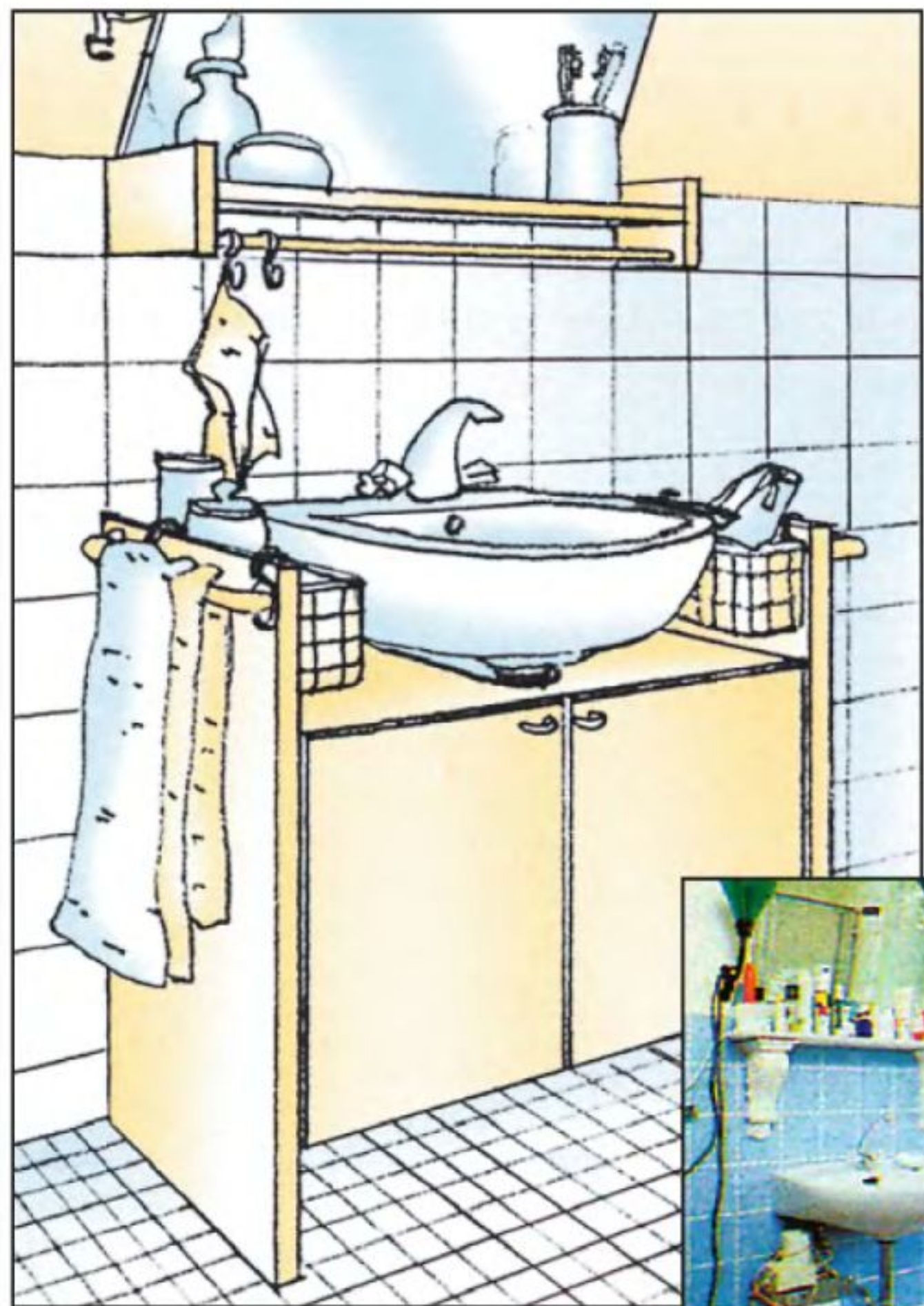
Рис. 9. Самодельная тумба укрывает проточный водонагреватель и сливную арматуру. Снаружи к боковым стенкам тумбы можно прикрепить ещё и полотенцедержатели.
