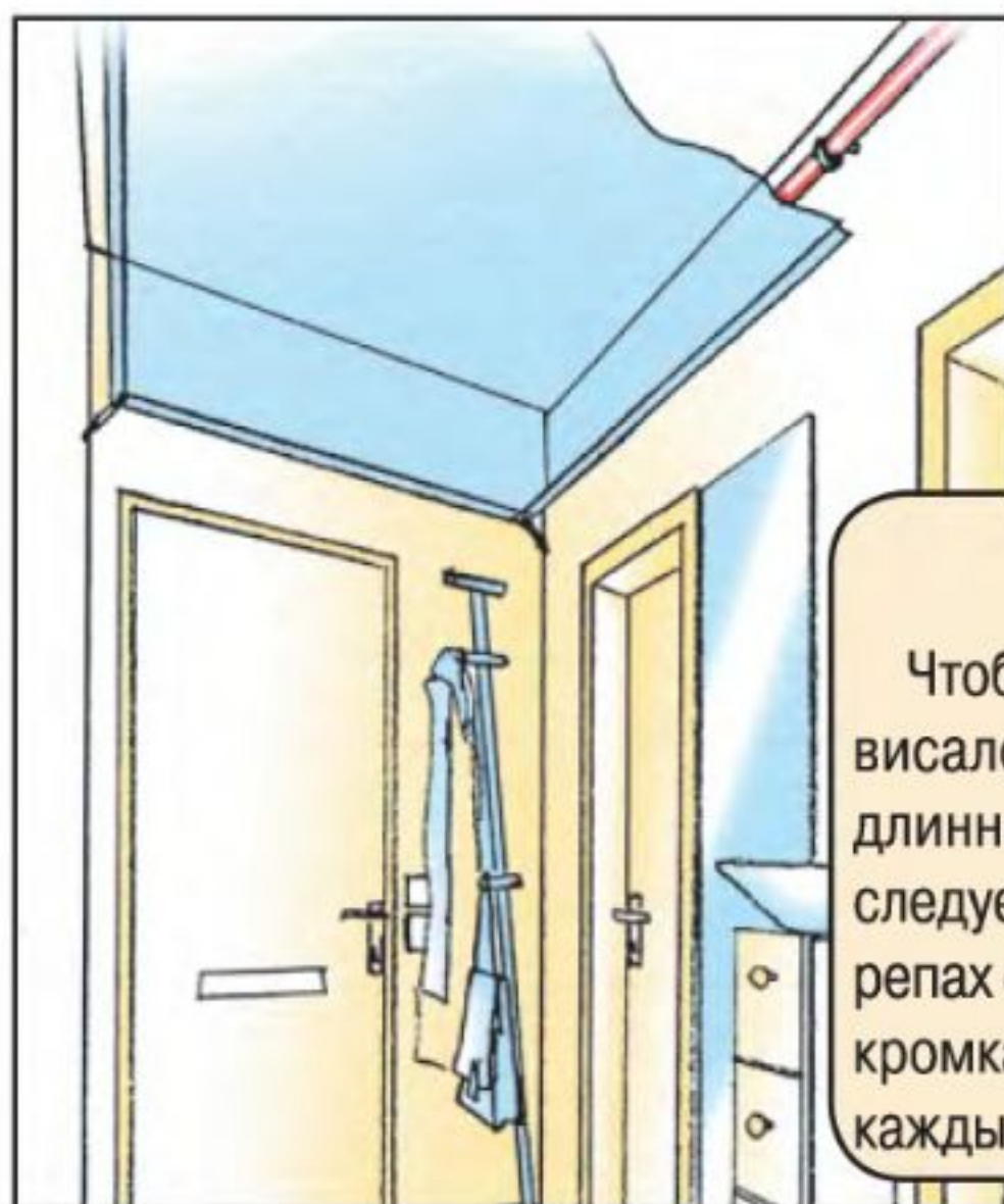
Рис. 2. Схема укрытия проложенных у потолка труб подвесной тканевой драпировкой.
